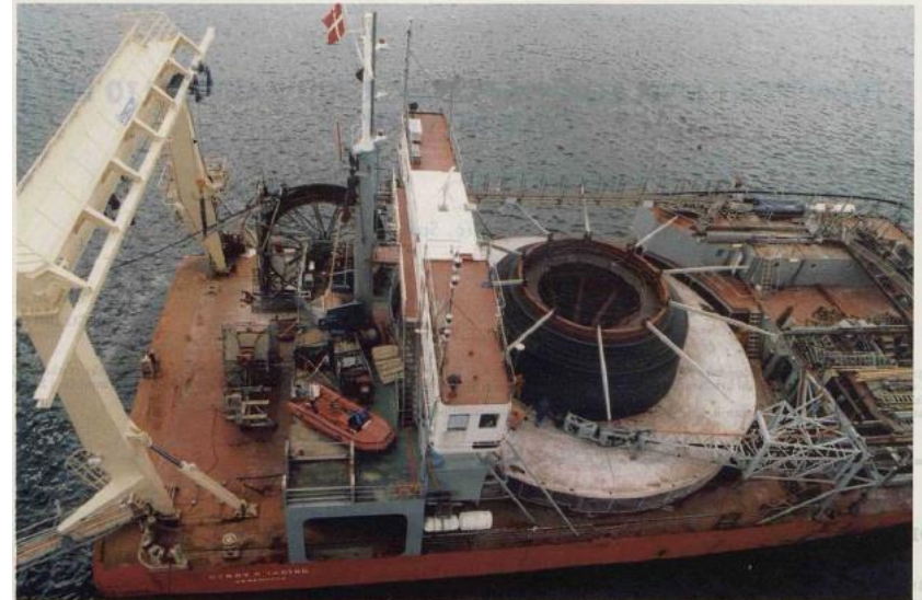
Slika 1. Utovar kabela na brod polagač
